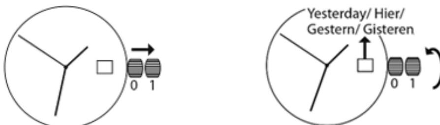
2. **Ziehen Sie die Krone auf Position 2 heraus. Der Sekundenzeiger bleibt stehen. Drücken Sie den Knopf A wiederholt, bis der Sekundenzeiger die Position 12 Uhr erreicht. Drehen Sie dann die Krone im Uhrzeigersinn, bis das genaue Datum von heute angezeigt wird. Drehen Sie dann den Minutenzeiger weiter, bis der Stundenzeiger und der Minutenzeiger auf 12 Uhr zeigen.**
